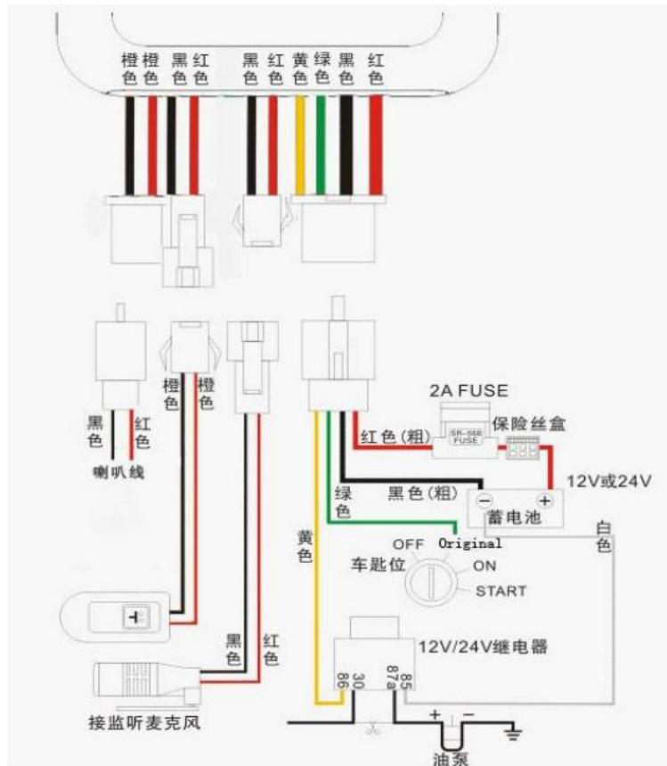
请选择原厂提供的电源线, 红色线为电源正极, 黑色为电源负极, 安装时电源负极, 请选择单独接地或搭铁, 勿与其他地线共接。需要 ACC 自动防盗功能的, 务必接上 ACC 线, 设备将 ACC 状态来决定是否进入设防状态; 若不接 ACC 线, 会使车辆进入设防状态, 在设防状态下车辆运行中发生震动, 将会触发震动报警。
