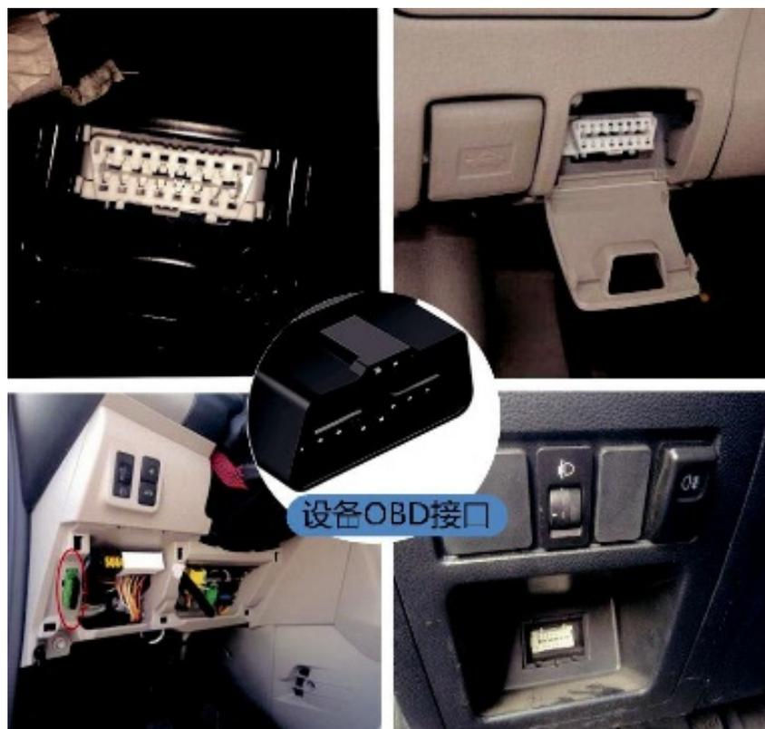
注：不同型号车辆 OBD 接口位置不同，下图是 OBD 接口可能存在的位置，有些车辆 OBD 口藏在塑料挡板之后：
